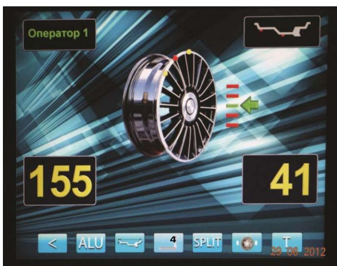
13.1. Программа Split используется при балансировке колес с высококачественными дисками из легких сплавов с целью сохранения внешнего вида колеса за счет установки невидимых снаружи балансировочных грузов за спицами обода.
