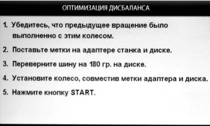
13.3 После выполнения п.5 в окне рис.14.1 на экране монитора появится окно рис 14.2, а на индикаторах 1 отобразится величина статического дебаланса колеса, а на индикаторах 4 величина дебаланса колеса, которую можно получить после завершения программы Opt. Поставьте метки нашине и диске
