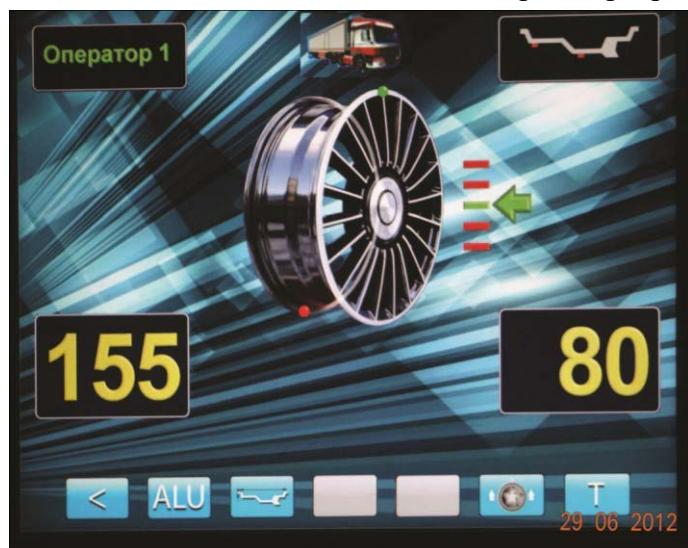
12.1.6. Запустите СБ, нажав кнопку "СТАРТ". На экране основного рабочего режима изображение диска колеса начнёт вращаться. После окончания цикла измерения автоматически включится тормозное устройство и вал СБ остановится. В окнах 1 и 4 появятся значения масс балансировочных грузов в граммах, а на изображении диска появятся две красные точки, отмечающие места их установки рис.12.2.
