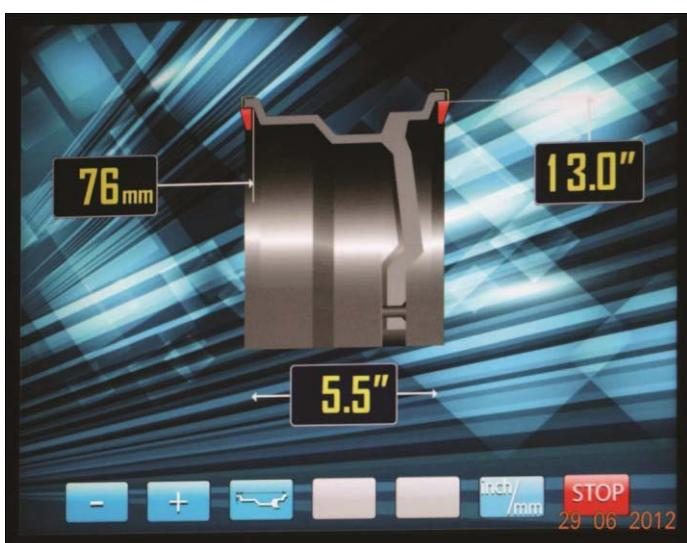
При включении питания СБ автоматически устанавливаются исходные параметры " $d$ " и " $b$ ", записанные в памяти СБ, которые можно проконтролировать нажимая кнопку A,d,b кнопка 3 на рис.10.2.
