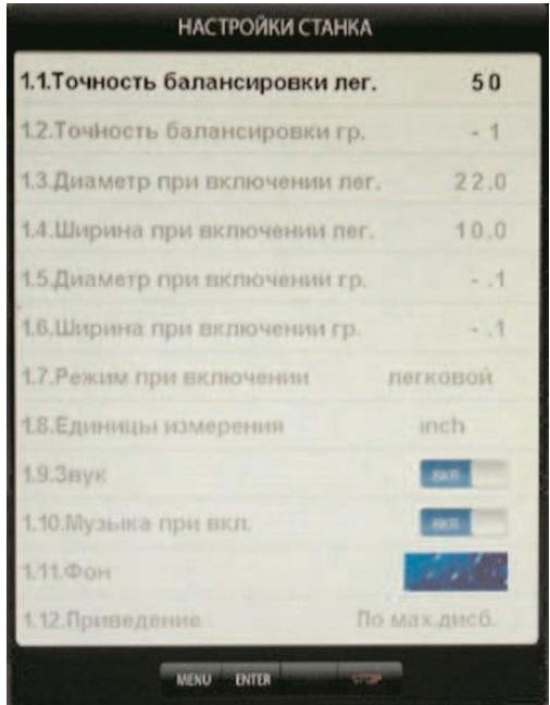
17.1. Параметры 1.1 и 1.2 "Точность балансировки лег." и "Точность балансировки гр" установка минимального дебаланса, отображаемого в окнах 1 и 4 (смотри пункт 12.2) в легковом и грузовом режимах. Для его изменения кнопками  $\emptyset$  выбрать параметр (выделяется цветом), кнопками "+" или "-" установить желаемое значение, нажать кнопку ENTER, программа вернётся в режим МЕНЮ, нажать кнопку STOP для возврата к основному рабочему экрану.
